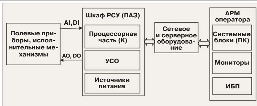
Рис. 1. Общая структурная схема АСУТП
